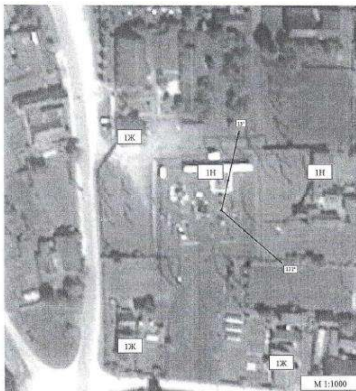
Рисунок 3 – Ситуационный план с указанием ЗОЗ (ЗОЗ 28,28,1м на H_{min}=49,6м , H подвеса антенн 50м, азимут 13^{\circ}, 131^{\circ} )
