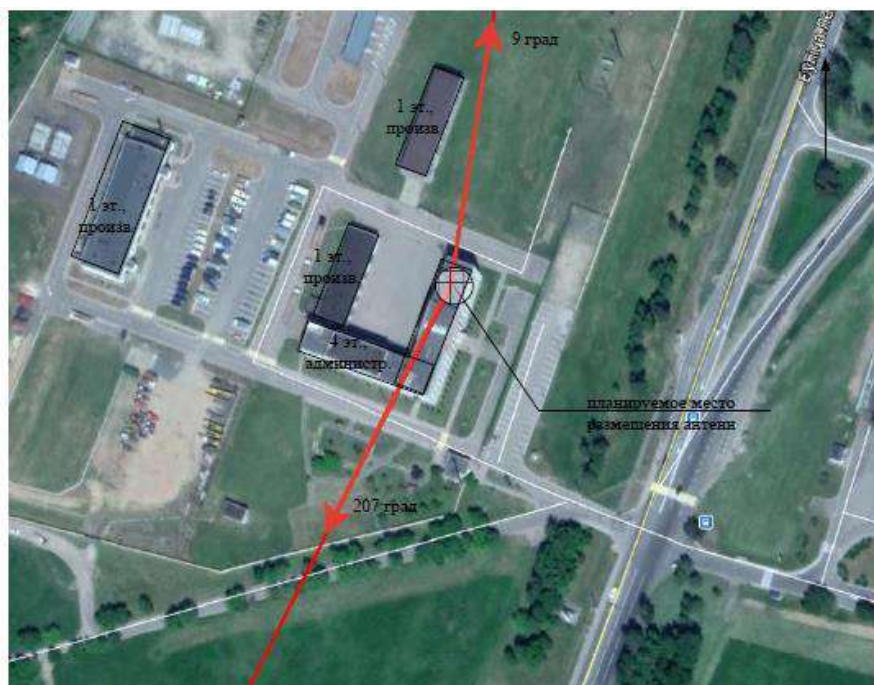
Рисунок 3 – Ситуационный план с указанием ЗОЗ (ЗОЗ 23,23,7м на Hmin=30,1м, Н подвеса антенны 35м, азимут 9°,207°)
