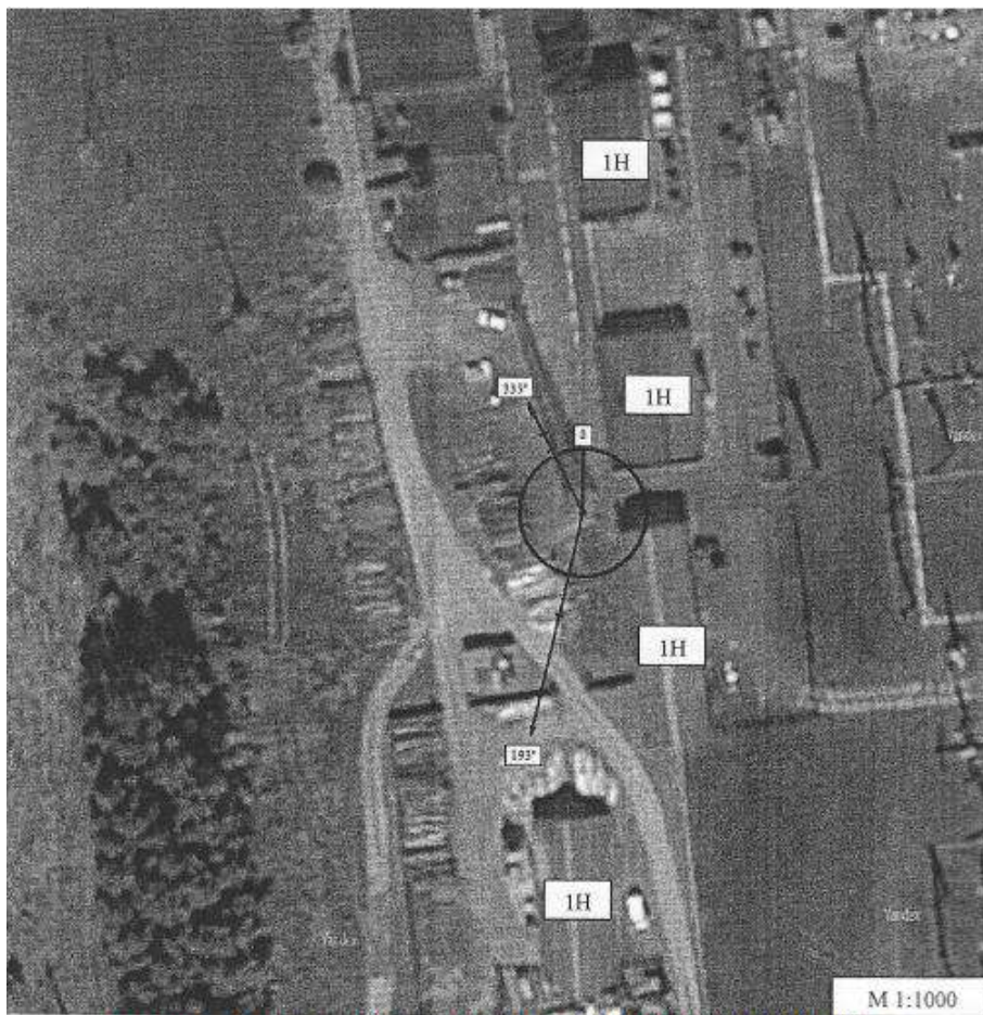
Рисунок 3 – Ситуационный план с указанием ЗОЗ (ЗОЗ 28,1 м на H_{\min}=41,3 м, H подвеса антенны 45 м, азимут 193^{\circ} )
