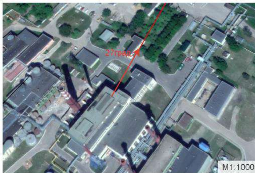
Рисунок 3 – Ситуационный план с указанием ЗОЗ (ЗОЗ 11,2м на H_{min}=26,8м , H подвеса антенны 27м, азимут 27°)
