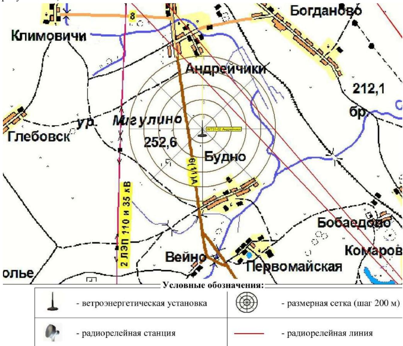
Рисунок 4.3. – Результаты расчётов обеспечения электромагнитной совместимости с радиоэлектронными средствами радиовещательной службы в районе размещения проектируемой ВЭУ
